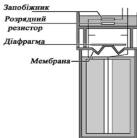
Рисунок 2.1 – Конструкція конденсатора низької напруги типу Varplus M
