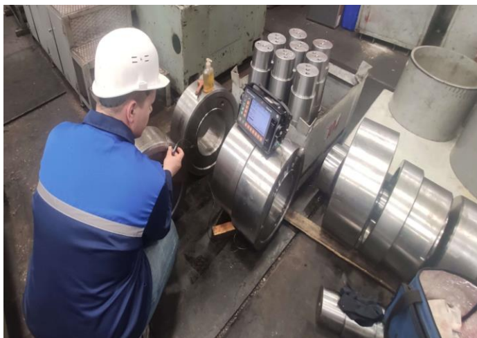
Рисунок 9.2 – Виконання ультразвукової дефектоскопії
