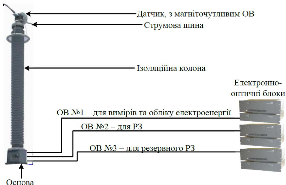
Рисунок 3.3 – Конструкція ізоляційної колони з пристроєм ВОТ
