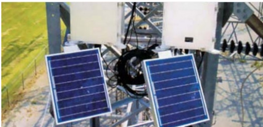
Рисунок 9.5 – Модуль живлення САТ-1. Вимірювальний модуль монтується на опорі
