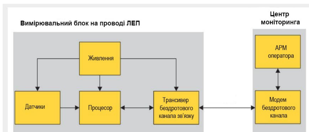
Рисунок 9.3 – Система моніторингу проводів ЛЕП
