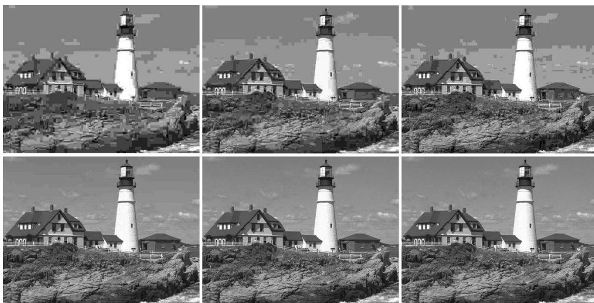
Рисунок 3.4 – Зображення №21 з бази KODAK після компресії для різних рівнів якості VIF (рядково зліва направо: 0.11, 0.21, 0.31, 0.46, 0.68 та 0.99)
