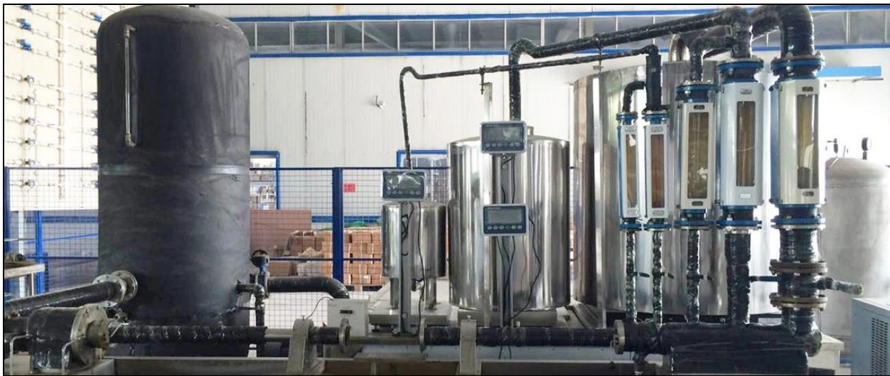
Рисунок 1.17 – Система ультразвукових лічильників води трубопровідної системи
