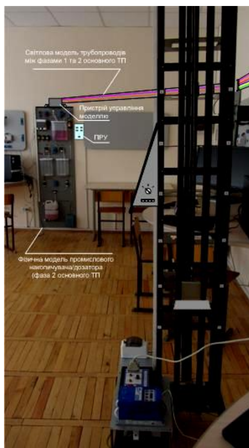
Рисунок 1.9 - Імітаційна модель рідких матеріальних потоків (системи трубопроводів) між фазами 1 і 2 основного ТП
