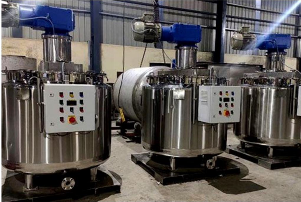
Рисунок 4.6 – Система «розумних» хімічних реакторів невеликого об'єму
