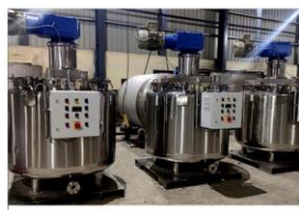
Система "розумних" хімічних реакторів невеликого об'єму
