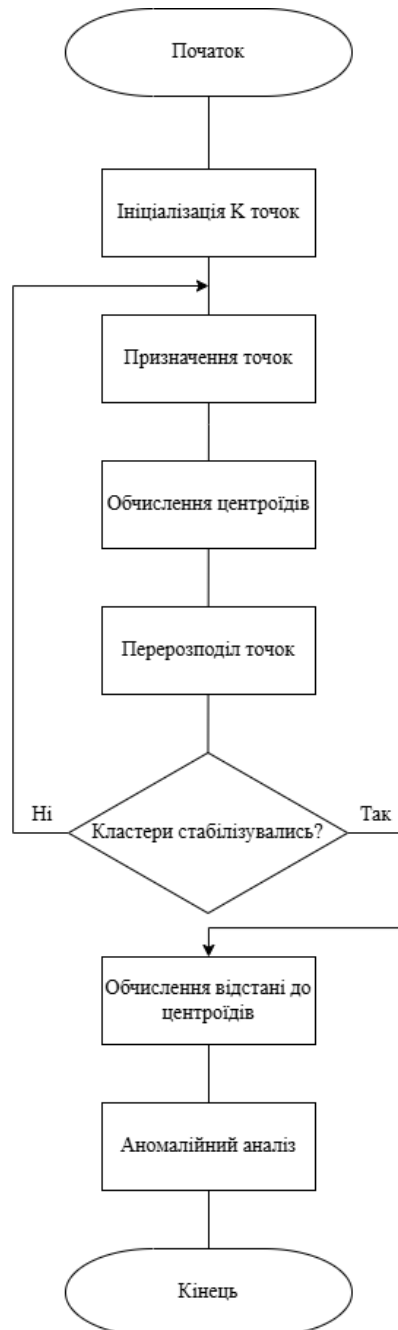
Рисунок 2.2 – Алгоритм роботи кластеризації з аналізом аномалій
