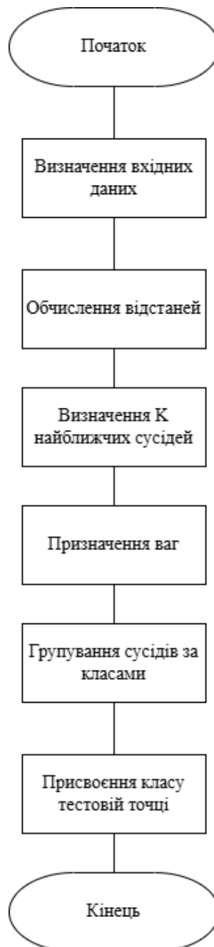
Рисунок 2.5 – Алгоритм роботи методу K-найближчі з індивідуальними вагами для кожного сусіда
