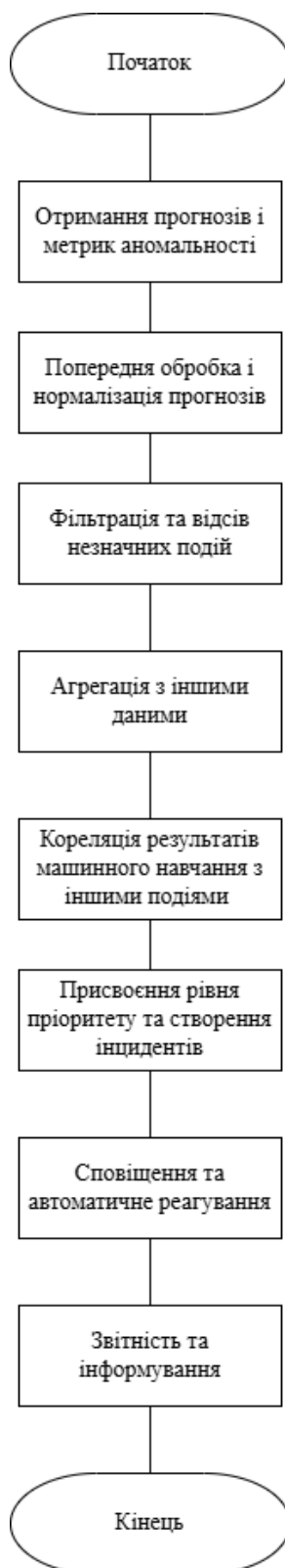
Рисунок 2.7 – Алгоритм дій SIEM-системи після отримання даних про події
