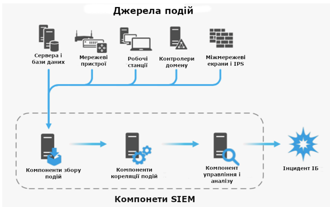
Рисунок 1.1 – схема роботи SIEM систем
