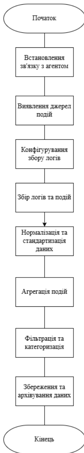
Рисунок 2.6 – Алгоритм збору даних SIEM-системою
