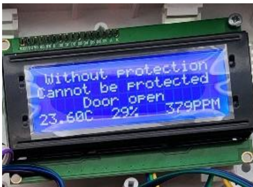
Рисунок 3.14 – Вивід помилки про неможливість поставити під охорону через відкриті двері
