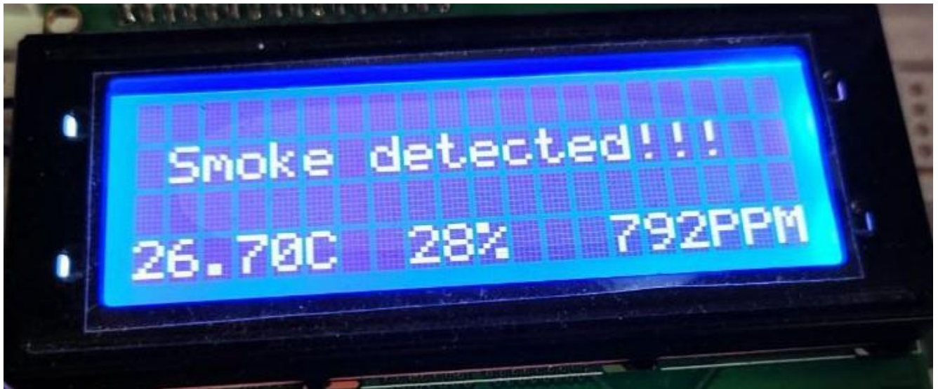
Рисунок 3.20 – Вивід на дисплей повідомлення про витік газу
