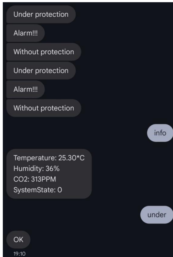
Рисунок 3.17 – Знімок екрану спілкування системи по GSM-каналі
