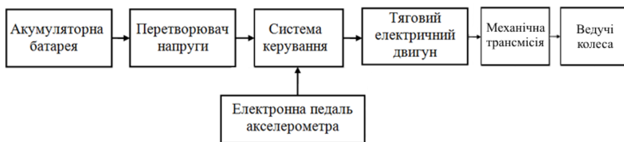
Рисунок 1.2 – Спрощена структурна схема електроприводу електромобіля
