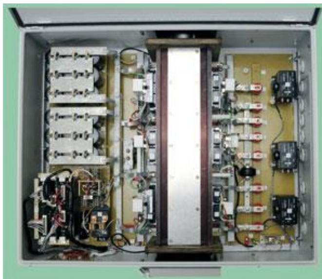
Рисунок 6.2 – Вигляд внутрішньої частини тягового перетворювача
