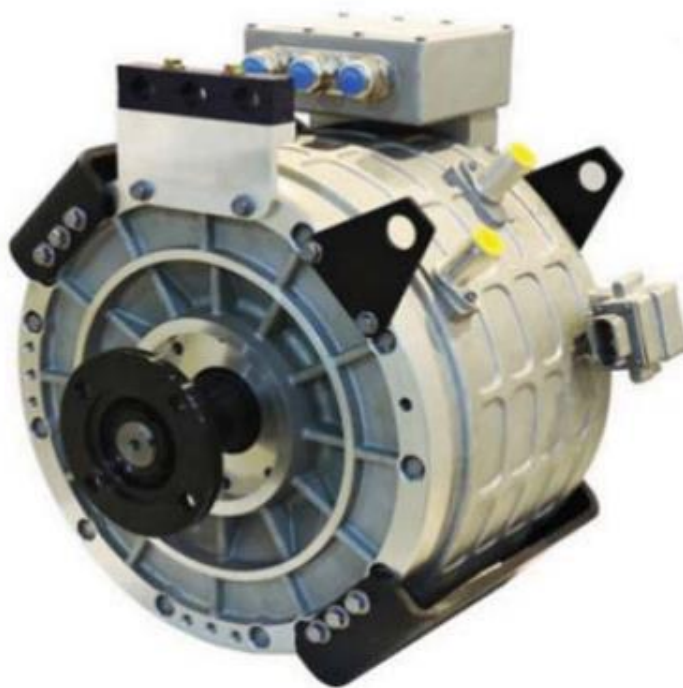
Рисунок 1.5 – Асинхронний тяговий двигун електромобіля
