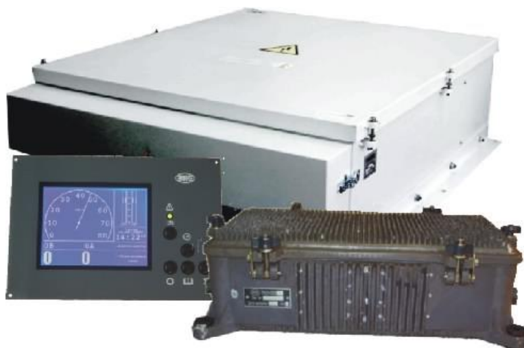
Рисунок 6.1 – Зовнішній вигляд тягового перетворювача з блоком індикації та блоком автономного ходу
