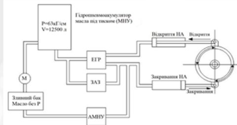
Функціональна схема гідравлічної частини НА
