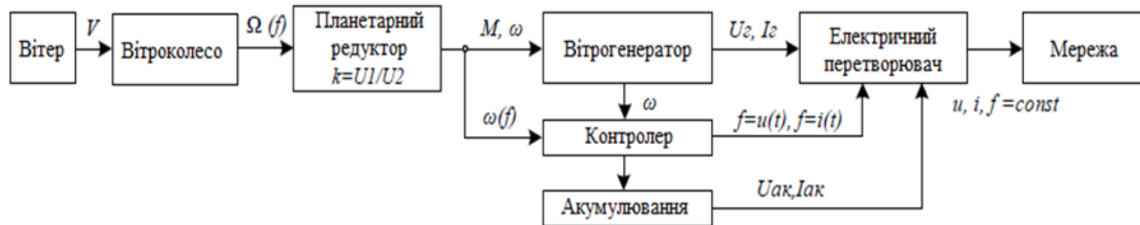
Рисунок 9 – Структурна схема моделі ВЕУ
