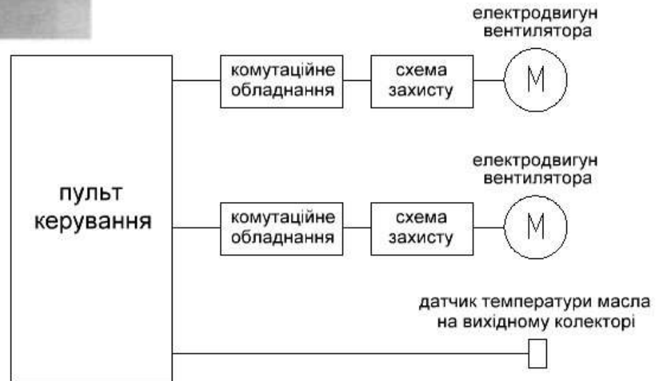
Функціональна схема системи керування установкою АПО масла
