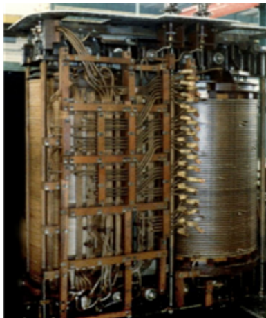
Трансформатор електровоза зі знятим захисним кожухом
