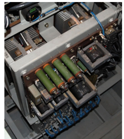
Перетворювач частоти та числа фаз для допоміжних ланцюгів електровоза
