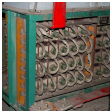
Діодна випрямна установка електровозу
