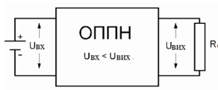
Рисунок 14 – Спрощена функціональна схема ОППН з еквівалентним навантаженням
