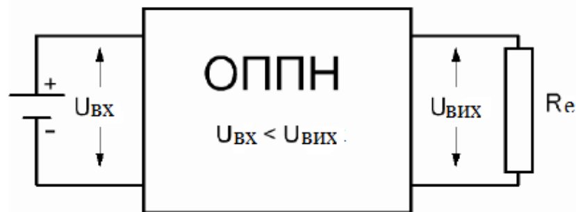
Рисунок 4.11 – Спрощена функціональна схема ОППН з еквівалентним навантаженням
