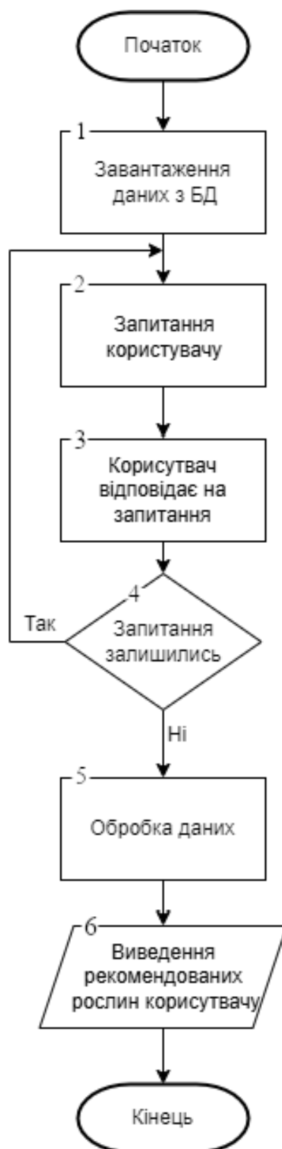
Рисунок В.5 – Схема алгоритму роботи системи надання рекомендацій по вибору кімнатної рослини
