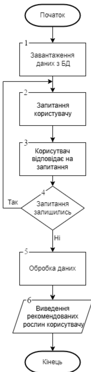
Рисунок 3.4 – Схема алгоритму роботи системи надання рекомендацій по вибору кімнатної рослини
