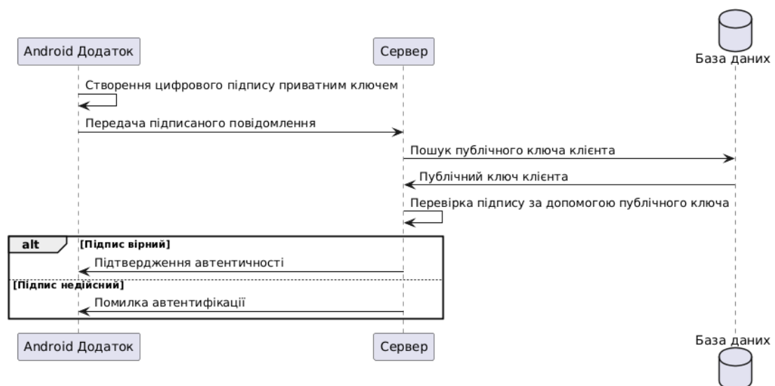
Рисунок 3.2 – Алгоритм перевірки автентичності повідомлення за допомогою цифрового підпису
