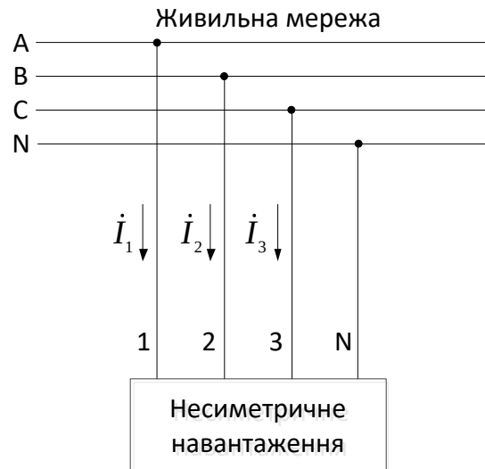
Рисунок 3.2 – Варіант під'єднання чотирипровідної лінії до лінії живлення
