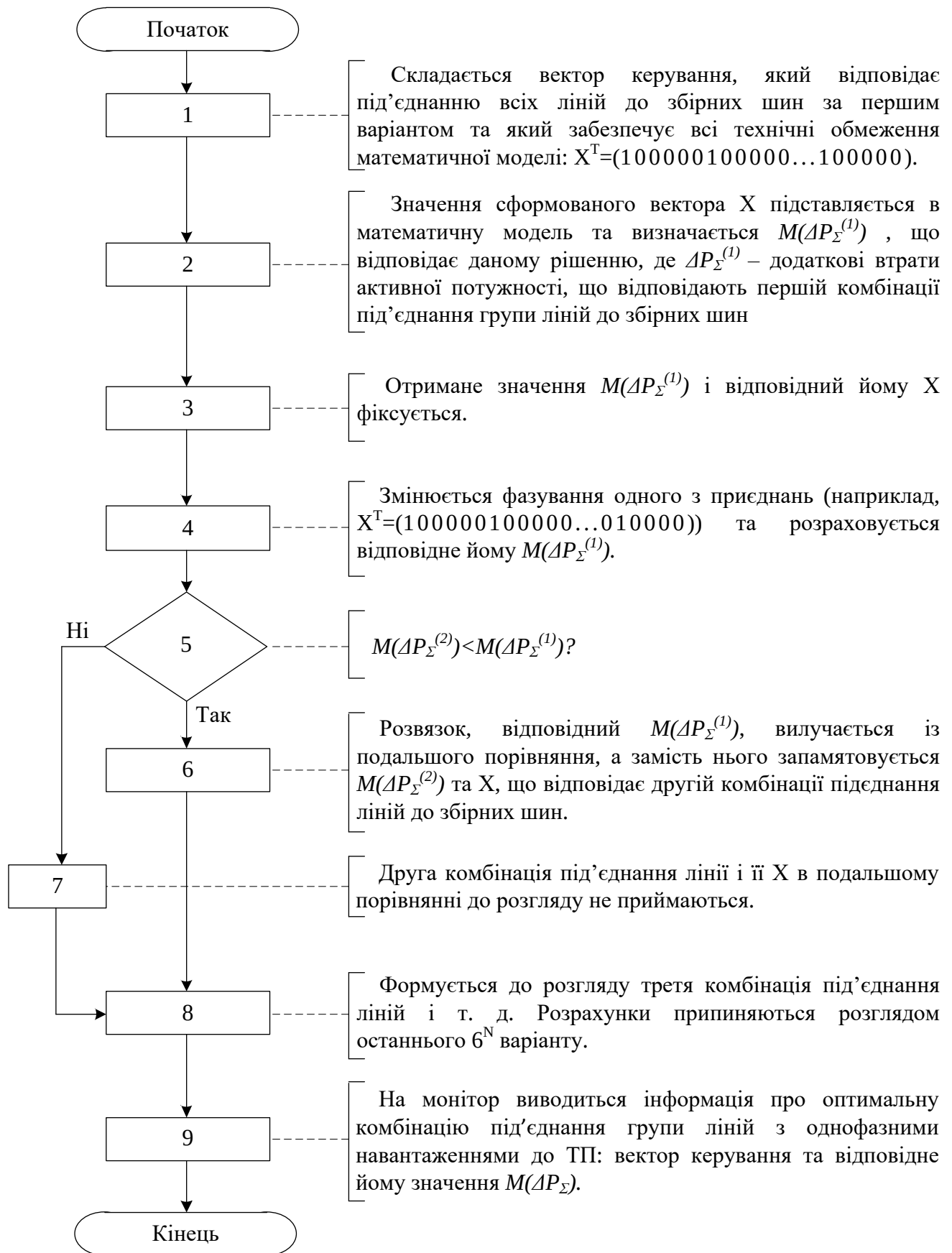
Рисунок 0.7 – Алгоритм суцільного перебору варіантів під'єднання групи ліній з однофазними навантаженнями для визначення оптимального
