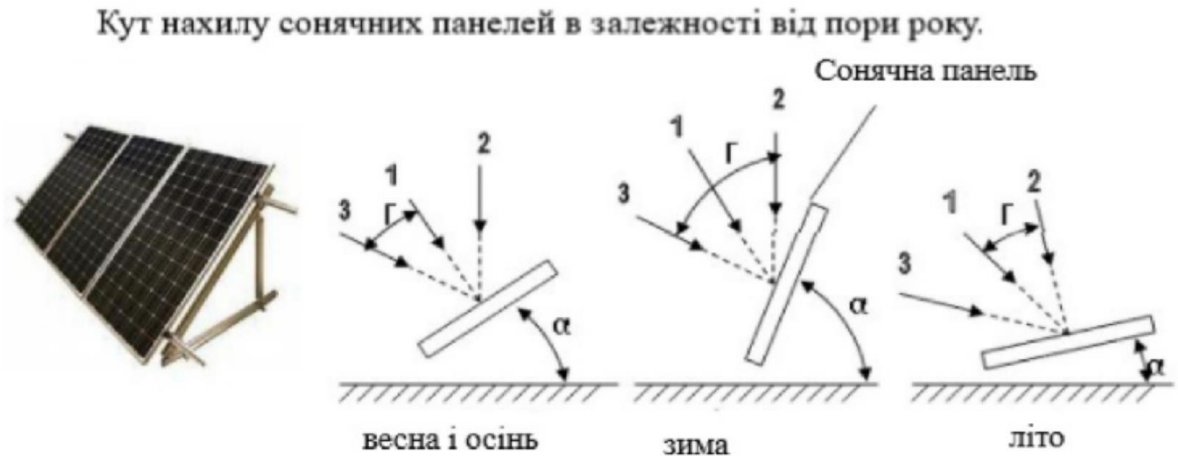
Рисунок 3.6 – Рекомендації щодо кута нахилу сонячних панелей, в залежності від пори року.
