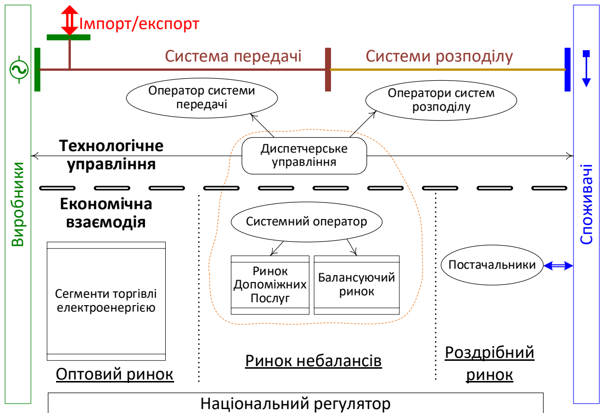
Рисунок 2.5 – Типова структура конкурентного ринку електричної енергії
