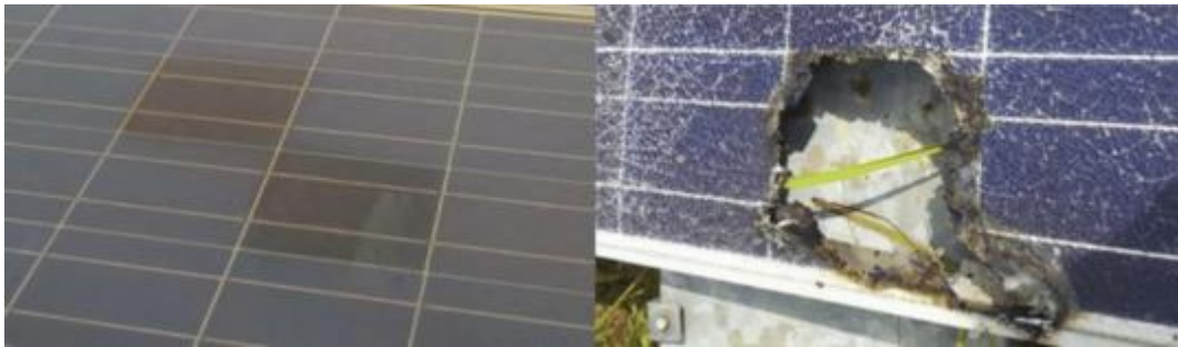
Рис. 4.4.3 - Фотоелектричний модуль з гарячими точками
