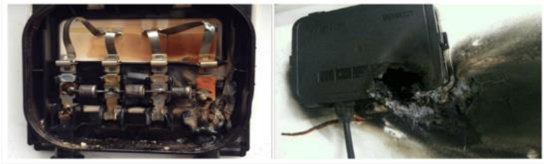
Рис. 4.4.8 - Несправності розподільної коробки
