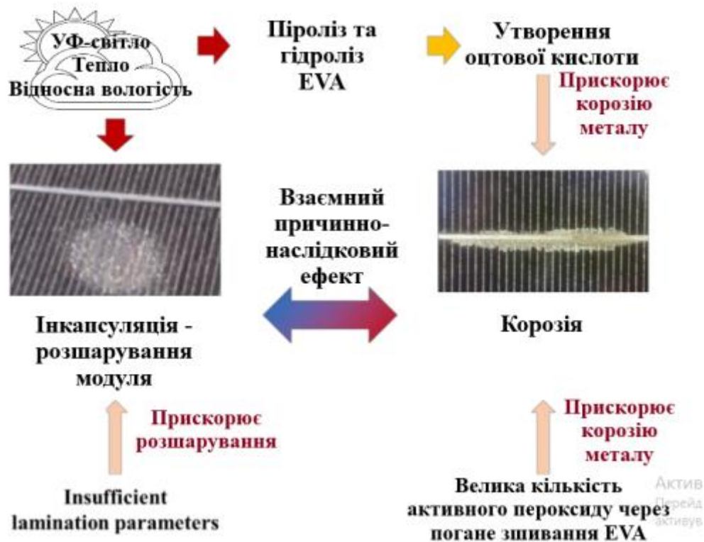
Рис. 4.4.4 - Механізм корозії сонячних елементів
