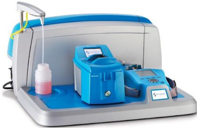
Рисунок 1.9 – Портативна мінілабораторія BALTECH OA «Oil Analyzer»
