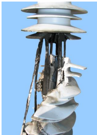
Рисунок 2.6 – Невдале випробування короткого замикання обмежувача без обмотки
