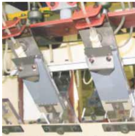
Рисунок 2.2 – Аналіз стійкості до ерозії трекінгу (випробування “TERT”)
