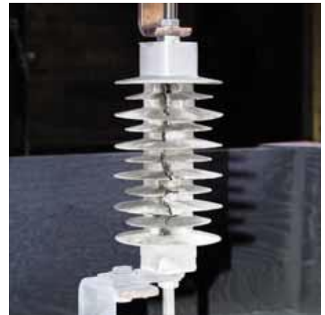
Рисунок 2.1 – ОПН високої напруги, що складається з двох частин
