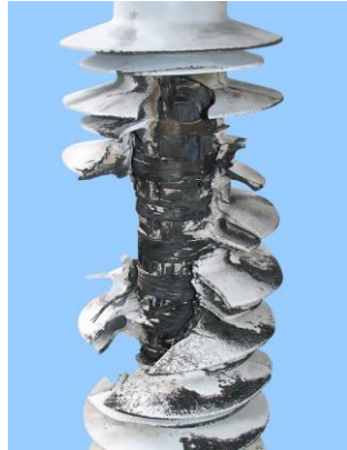
Рисунок 2.5 – Успішне випробування короткого замикання обмежувача перенапруг PEXLIM із обмоткою
