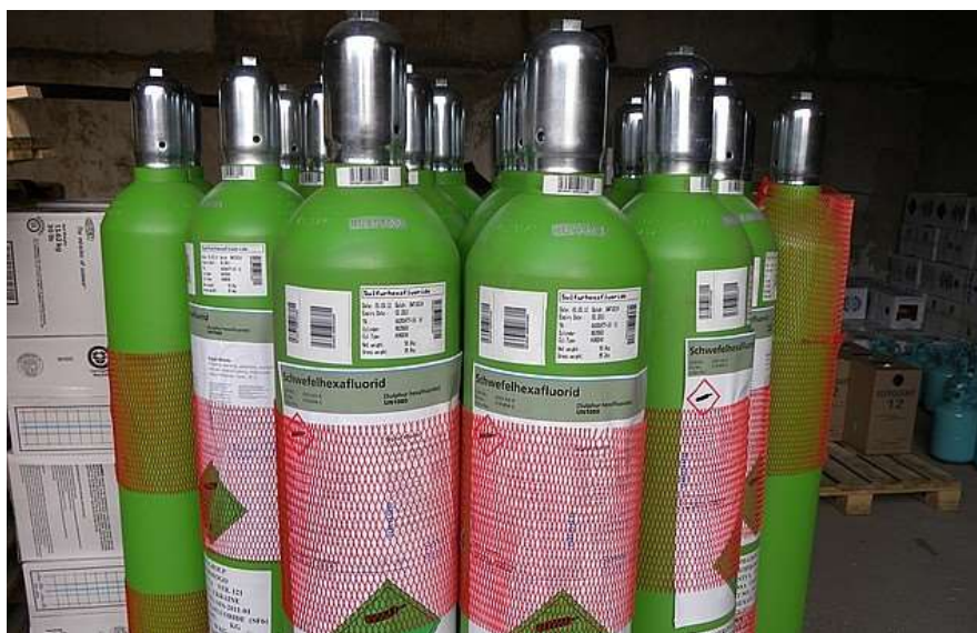
Рисунок 3.21- Резервуар для зберігання \text{SF}_6
