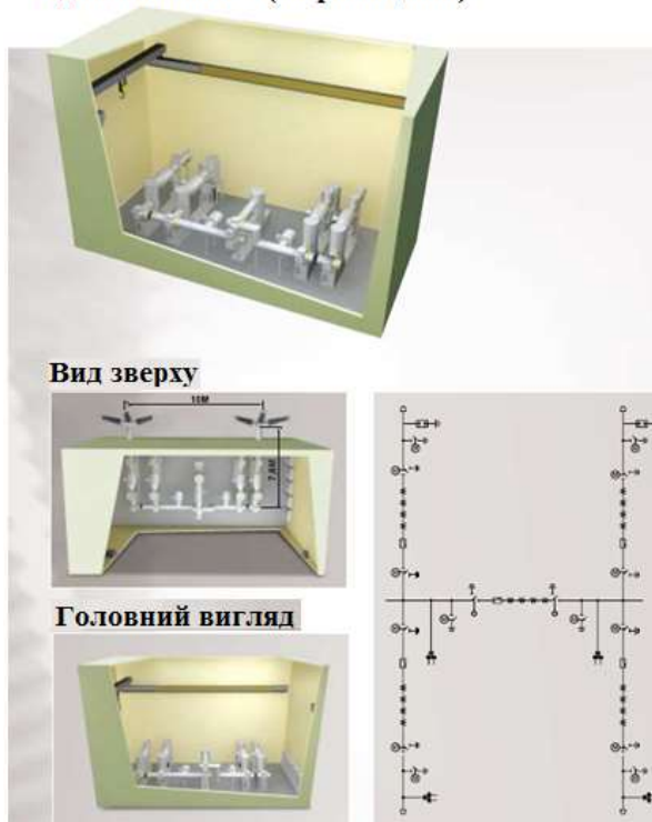
Рисунок 3.8 - КРУЕ 110 в приміщенні
