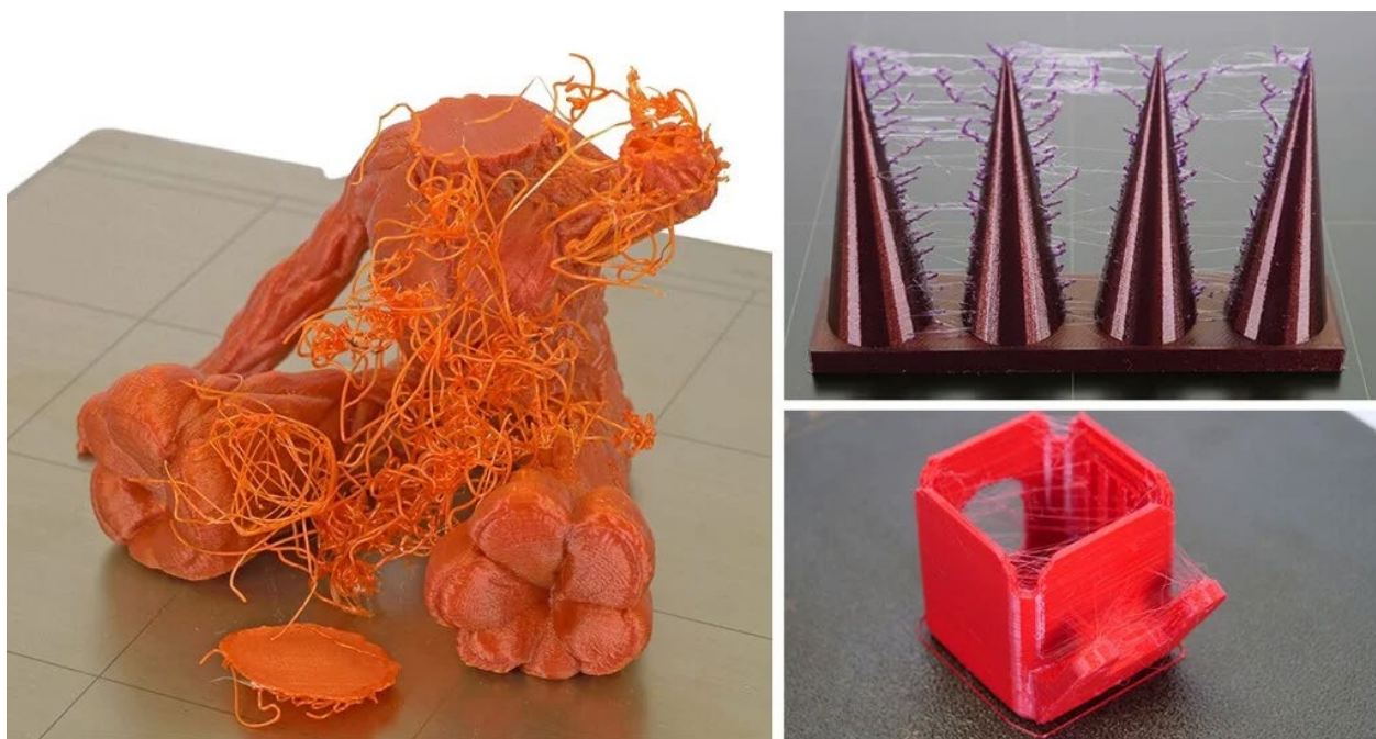
Рисунок 1.2 – Загальний вигляд різних моделей із дефектами в результаті друку
