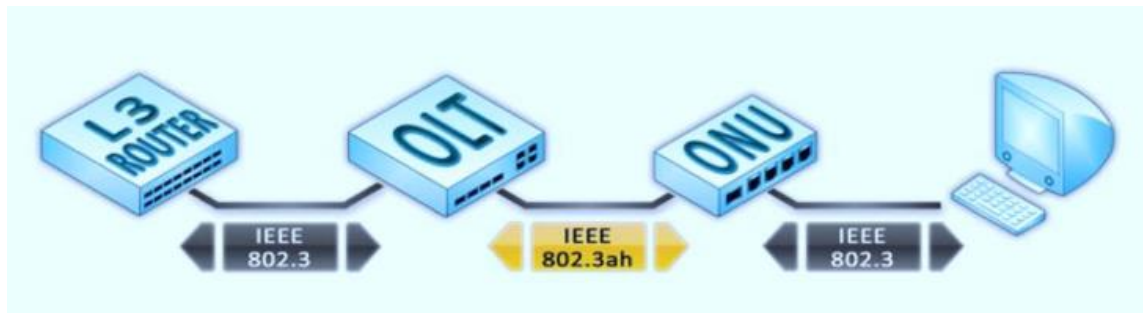
Рисунок 1.7 – Процес перетворення пакетів у мережі PON
