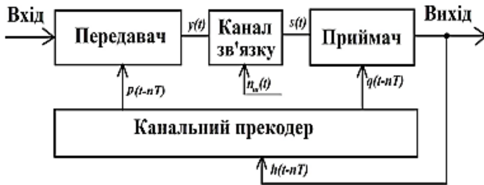
Рисунок 2.23 – Структурна схема OTDM-системи з каналним прекодером
