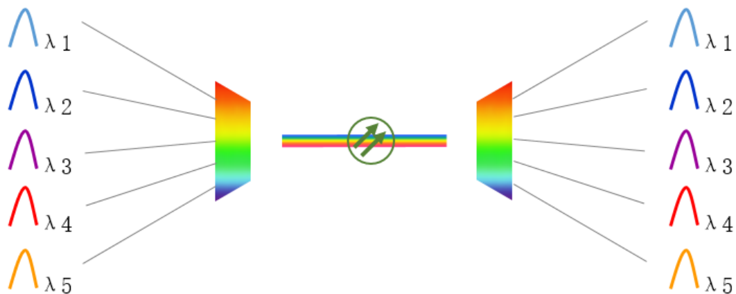
Рисунок 1.3 – Принцип роботи WDM
