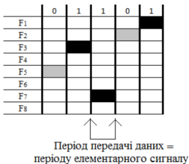
Рисунок 2.6 – Вигляд процесу повільної зміни частотного каналу
