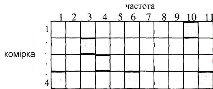
Рисунок 2.2 – Розподіл частотних каналів для чотирьохкоміркової мережі
