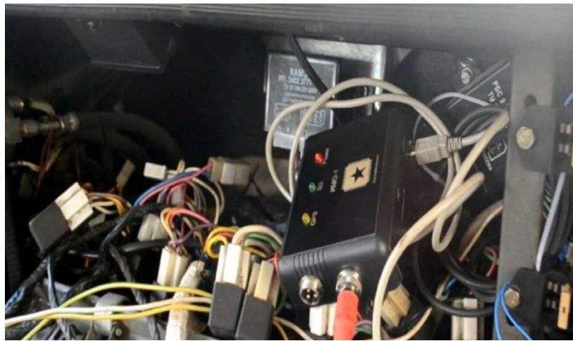
Рисунок 3.7 - Місце встановлення терміналу на сміттєвозі
