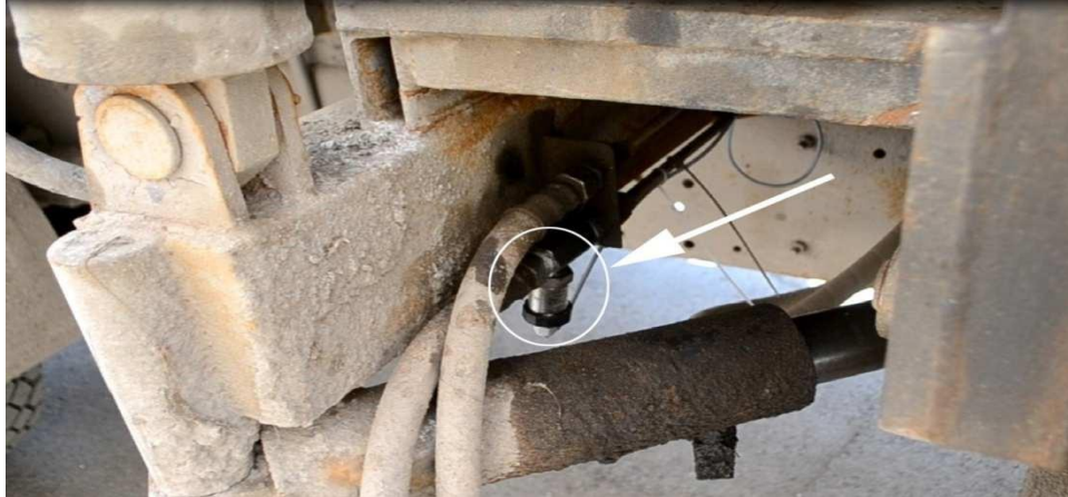
Рисунок 3.9 - Місце встановлення датчика тиску на сміттєвозі
