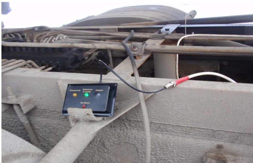
Рисунок 3.8 – Розташування індикаторного блоку під час експерименту
