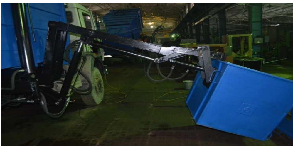
Рисунок 3.11 - Положення маніпулятора під час тарування
