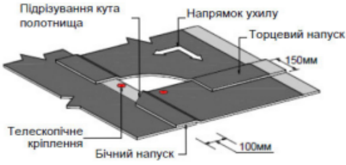
Напуски полотнищ рулонного матеріалу
