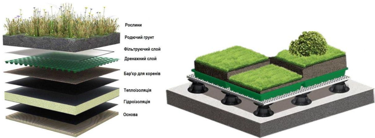
Рисунок 3.1 – Конструкція зеленого даху
