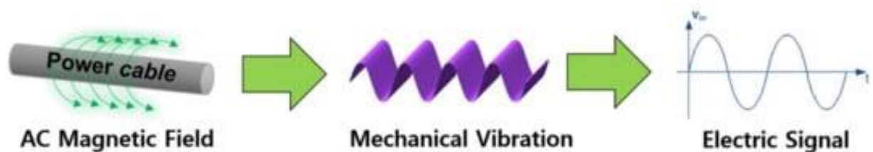
Рисунок 1.1 – Механізм роботи магнітомеханоелектричного перетворення
