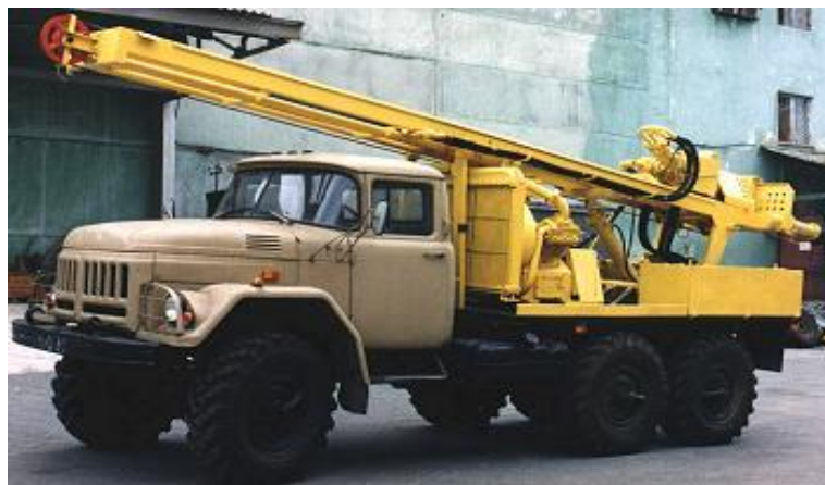
Рисунок 2.1 – Загальний вигляд бурової установки УРБ-2А-2
