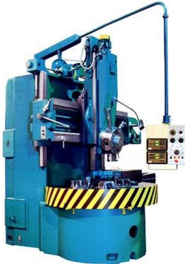
Рисунок 2.1 – Одностійковий токарно-карусельний верстат моделі 1516
