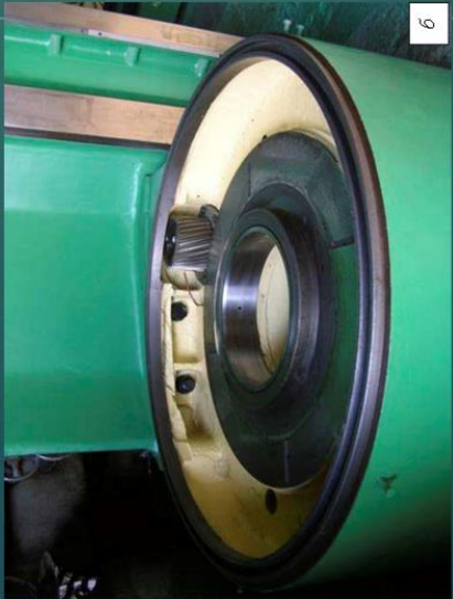
а – стіл верстата; б – корпус стола верстата. Рисунок 2.5 – Механізм повороту стола токарно-карусельного верстата 1516
