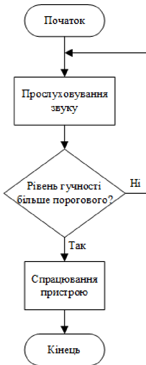
Рисунок 2.1 — Блок-схема алгоритму роботи акустичного вимикача мережевого освітлення
