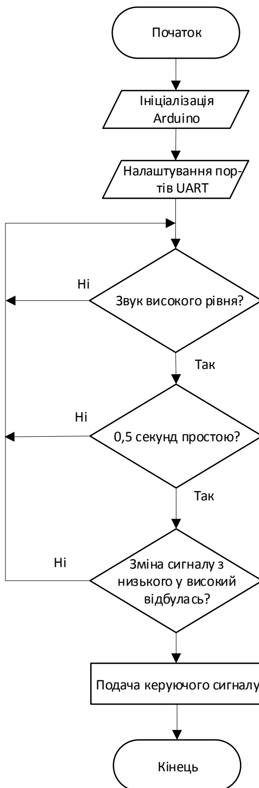
Рисунок 3.1 — Блок-схема акустичного перемикача на основі Arduino Uno
