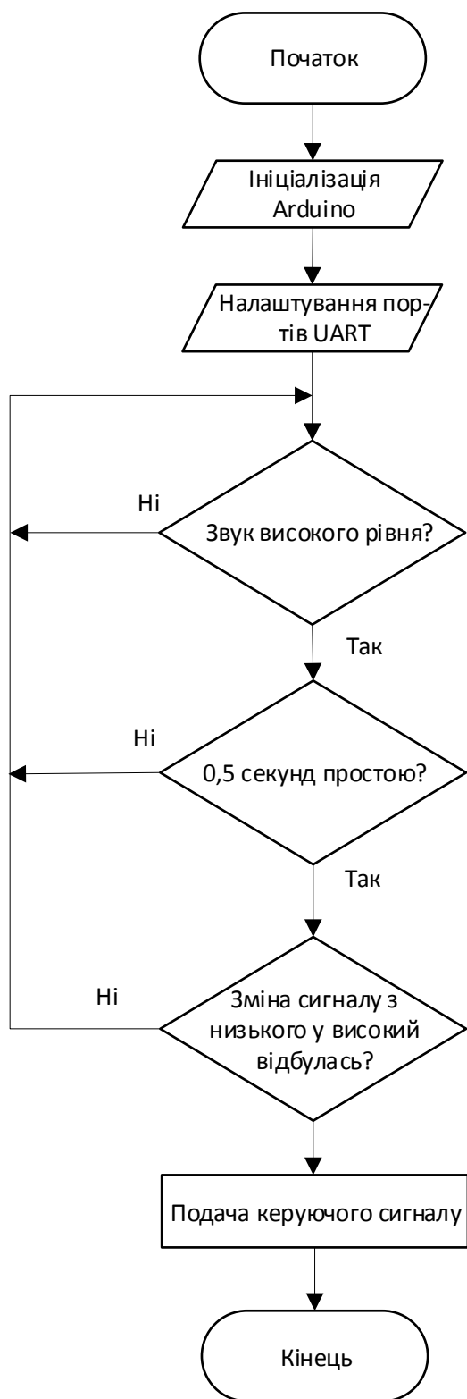
Рисунок 3.1 — Блок-схема акустичного перемикача на основі Arduino Uno
