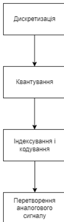
Рисунок 1.1 — Процес перетворення аналогового сигналу на цифровий
