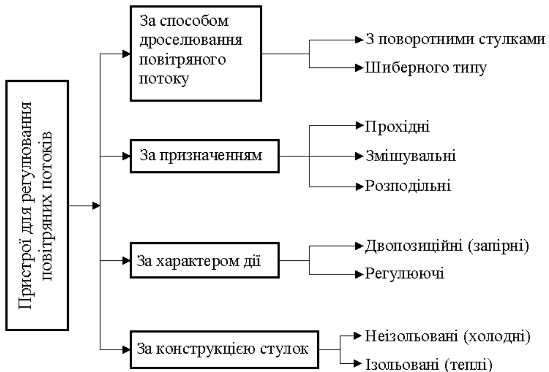
Рисунок 1.1 – Класифікація пристроїв для регулювання повітряних потоків
