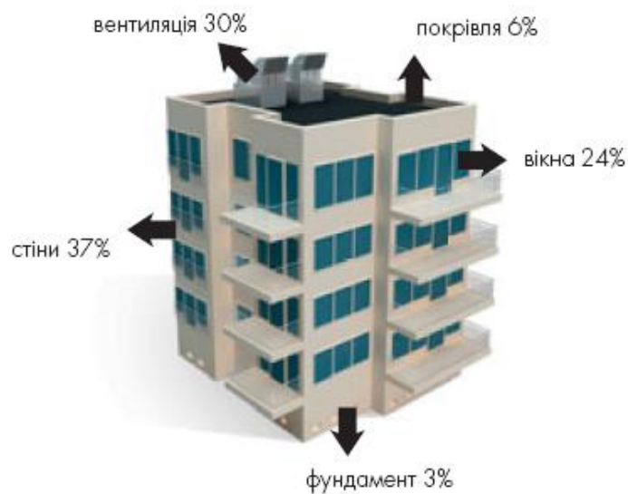
Рисунок 2 – Статистика втрат тепла в багатоповерховому будинку
