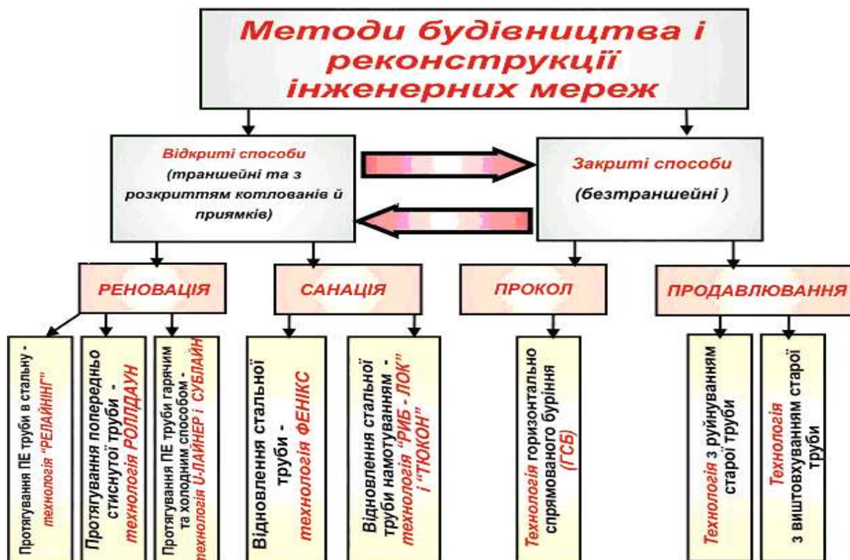
Рис. 2.34 – Методи будівництва й реконструкції інженерних мереж
