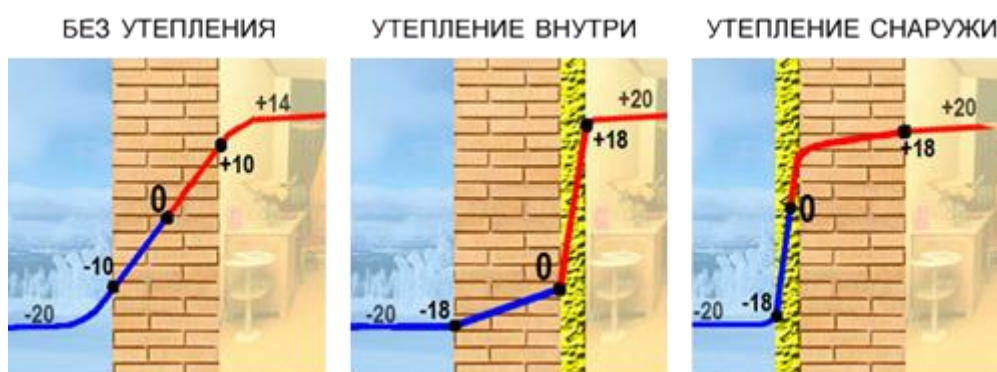
Рисунок 5 – Розміщення точки роси в залежності від конструкції стіни
