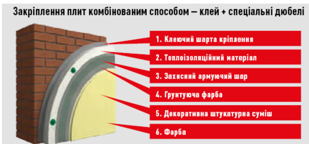
Рисунок 13 – Система зовнішньої скріпленої теплоізоляції
