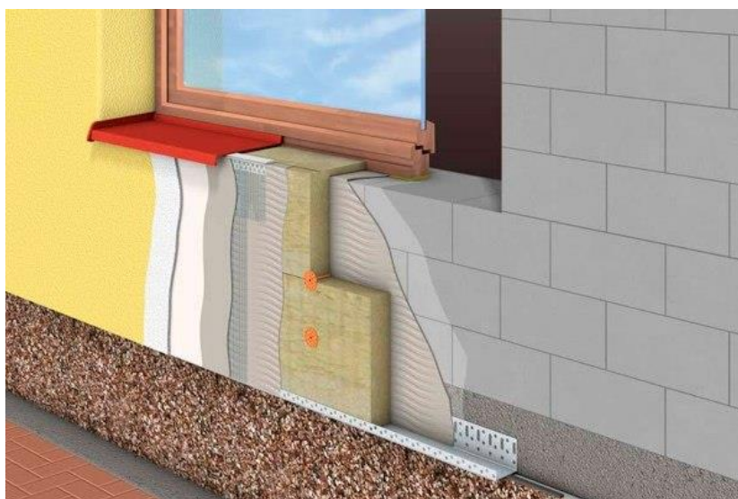
Рисунок 4 – Конструкція утепленого фасаду
