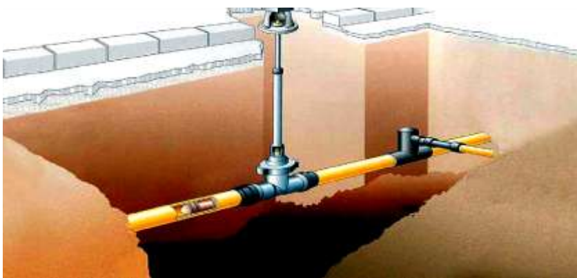
Рис. 2.41 – Розташування клапана «Газ-стоп» у відводі сиделки
