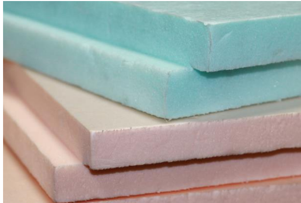
Рисунок 8 – Плити з пінопласту екструдованого пінополістиролу
