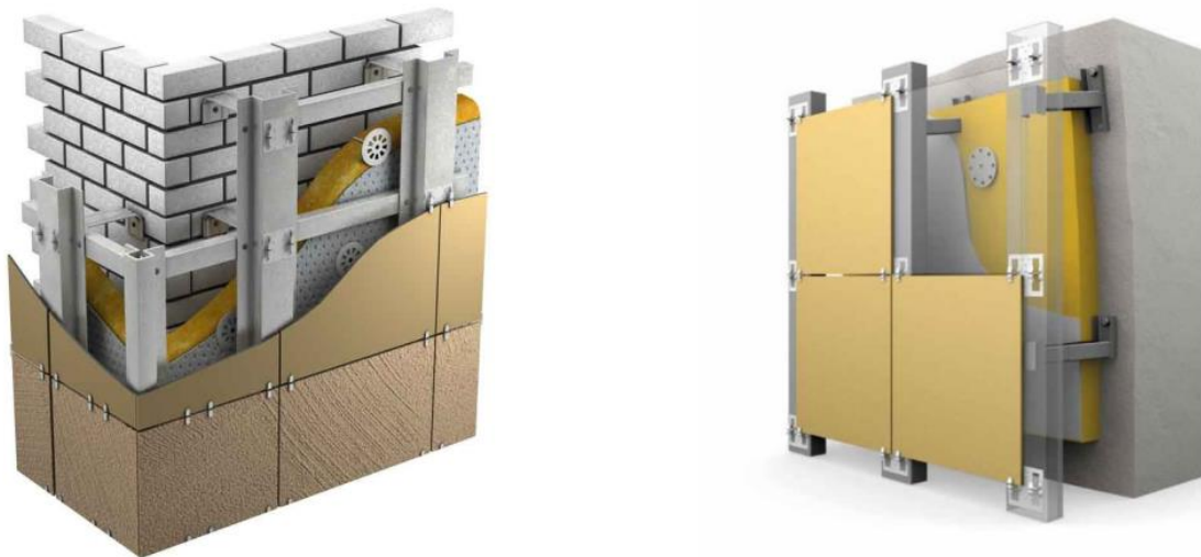
Рисунок 1 – Улаштування вентилязованого фасаду
