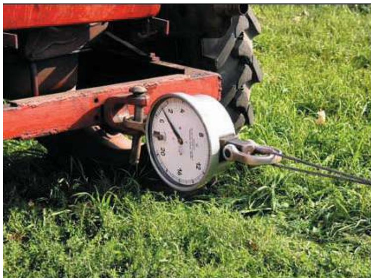
Рис. 3.29 – Приєднання сталюго троса до буксировочної головки
