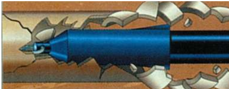
Рис.3.55 – Комбінація з передньою установкою бурової головки і проміжною протяжкою розширювача
