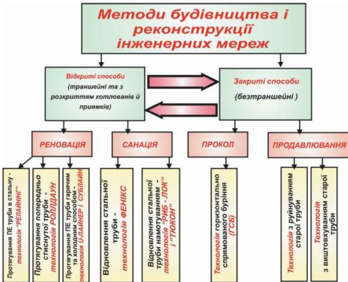
Рис. 3.26 – Методи будівництва й реконструкції інженерних мереж
