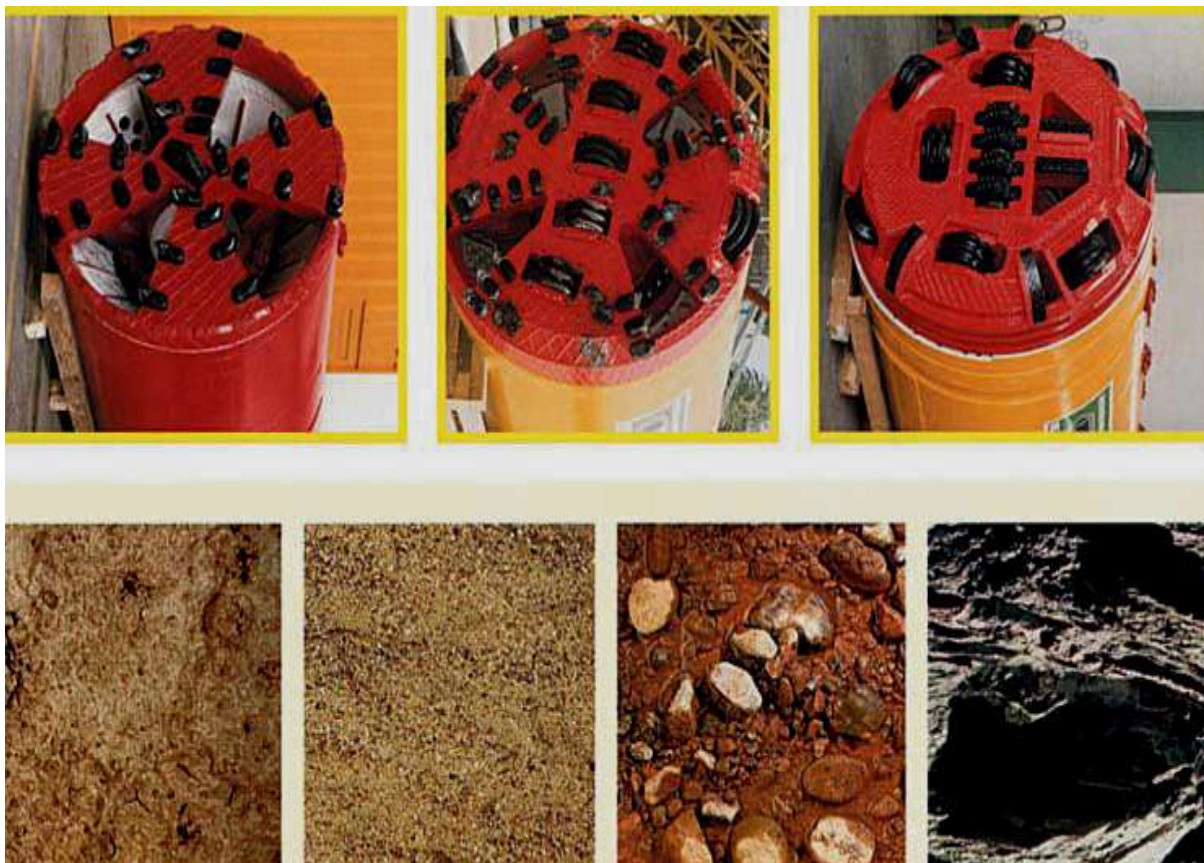
Рис. 3.59 – Зразки бурових головок для різних порід ґрунту
