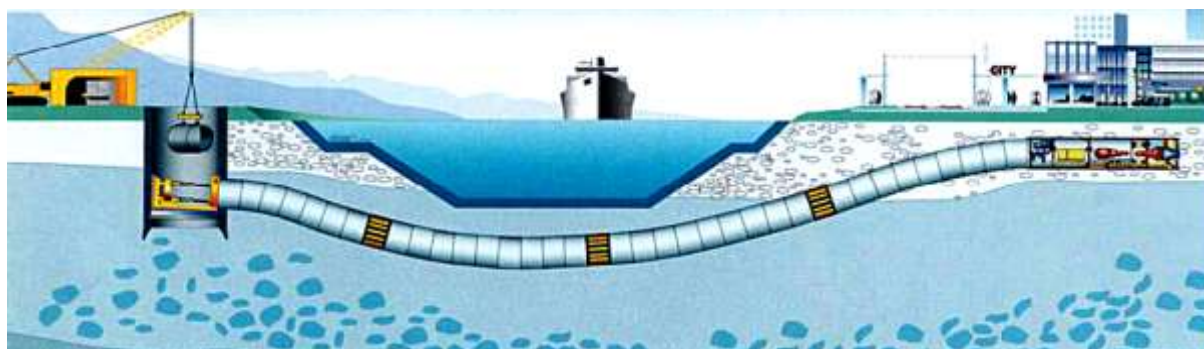
Рис. 3.60 – Процес нарощування кілець і збільшення величини пілотної свердловини
