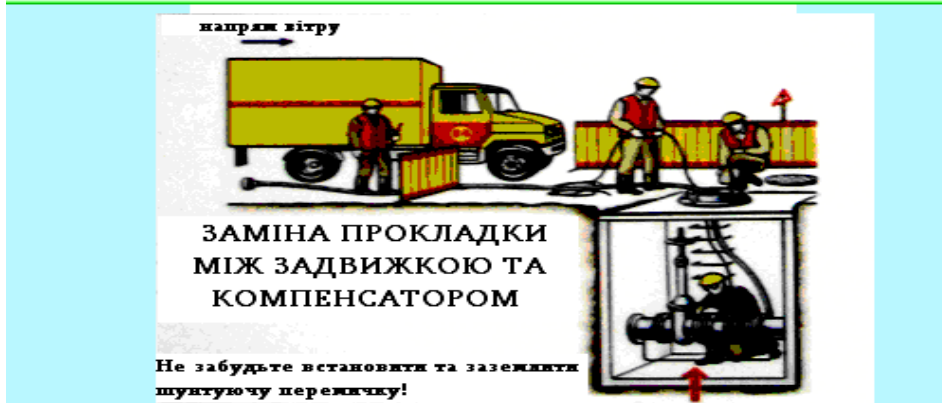
Рис. 3.16 - Газонебезпечні роботи в колодязях
