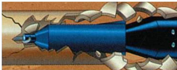
Рис. 3.56 – Комбінація з передньою установкою бурової головки і прямим приєднанням розширювача
