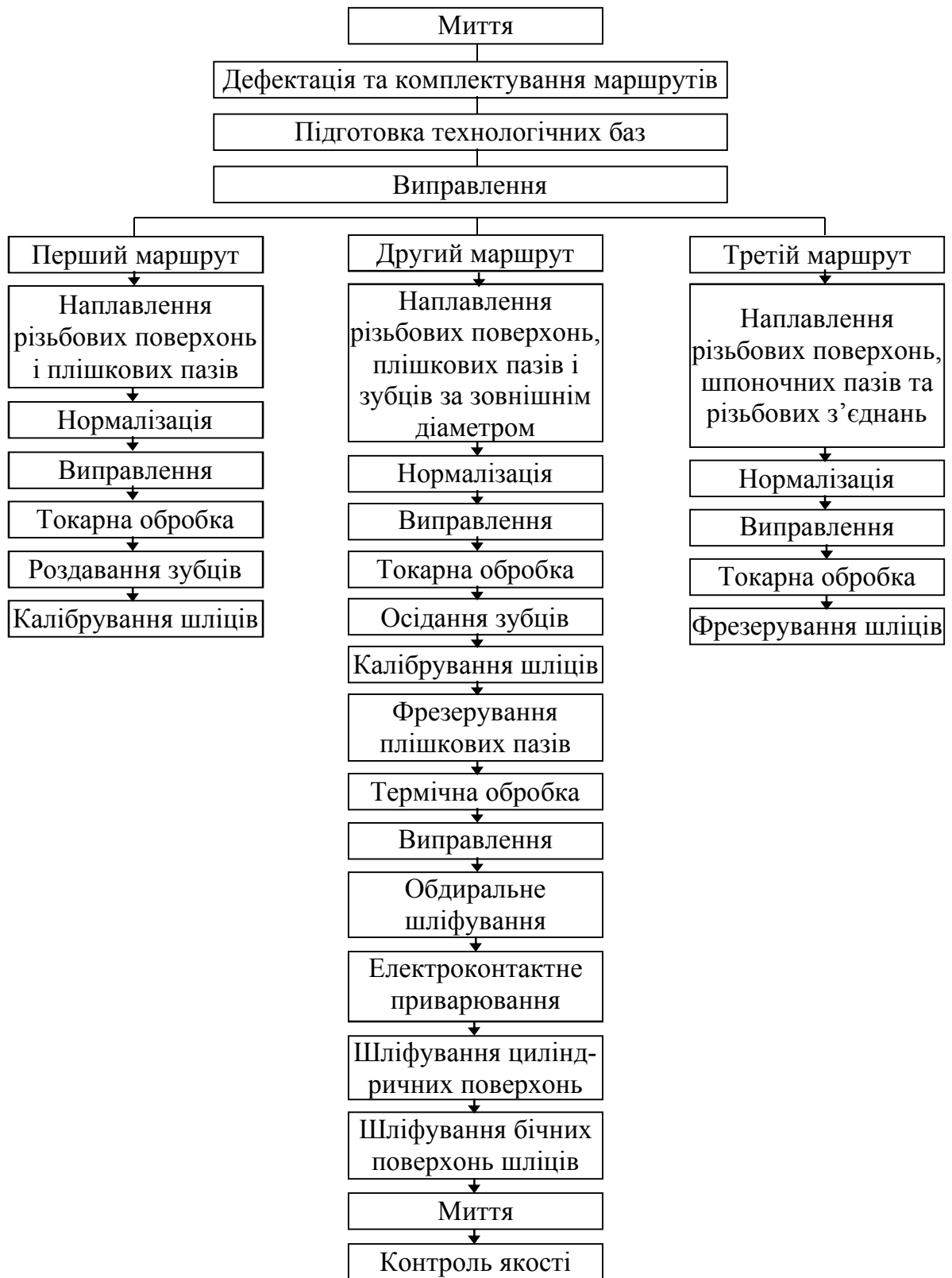
Рисунок 4.3 – Схема технологічного процесу відновлення шліцевих валів
