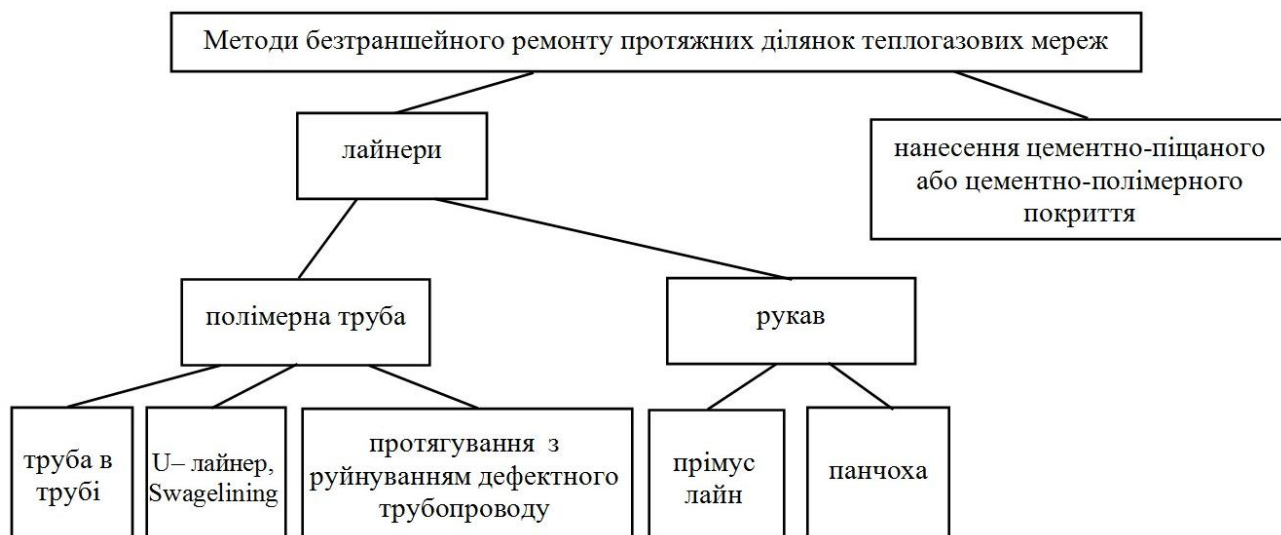
Рисунок 3 – Методи безтраншейного ремонту протяжних ділянок теплогазових мереж
