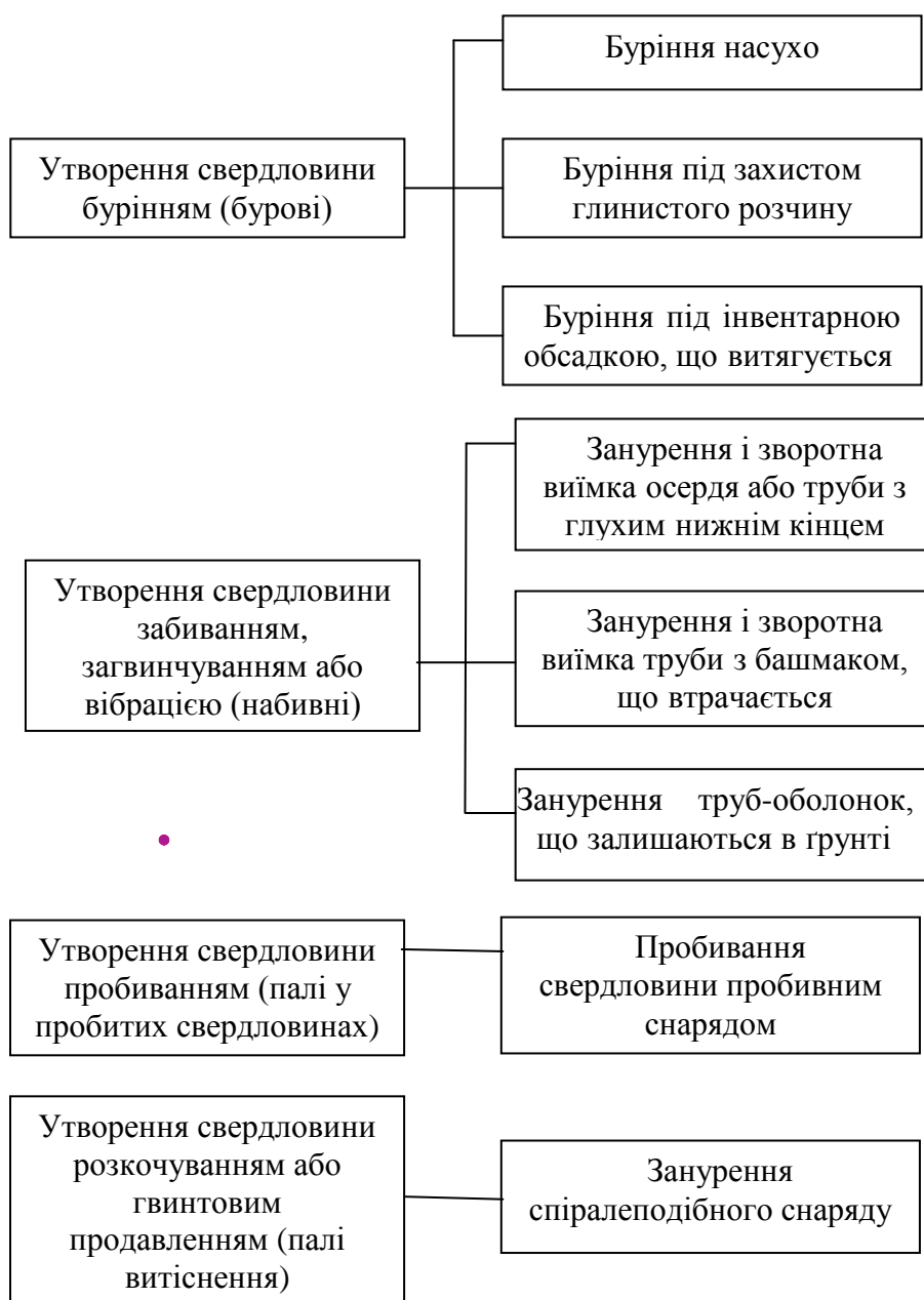
Рисунок 1.14 – Способи улаштування свердловин для набивних пиль
