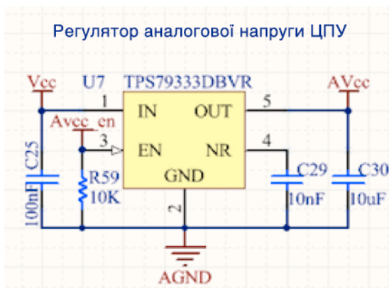
Рисунок 3.9 – Схеми електричні принципи: a – модуля зарядного пристрою; б – стабілізатора для формування аналогової напруги; в – стабілізатора для формування цифрової напруги
