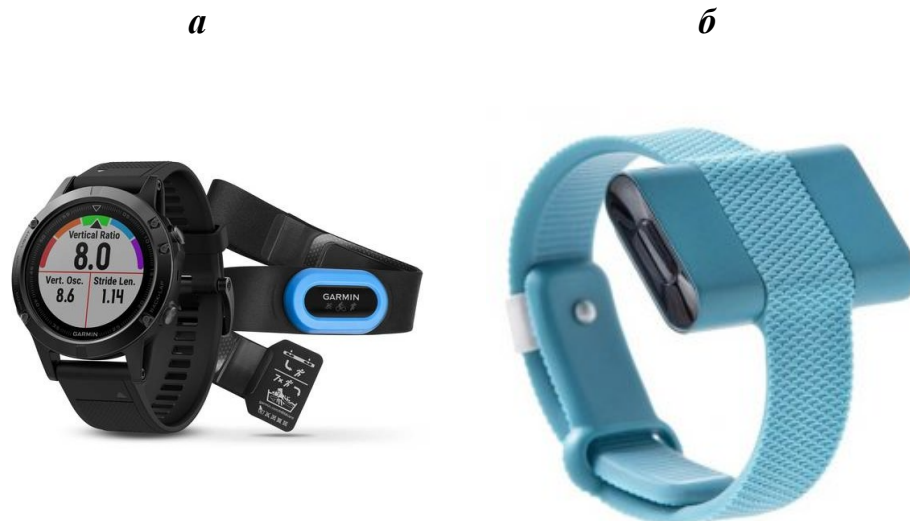
Рисунок 1.10 – Приклади носимих серцевих моніторів: а – серцевий монітор GARMIN у вигляді нагрудного ременю та годинник, для синхронізації та візуалізації даних; б – носимий монітор варіабельності ритму серця SenceBand, що здатен реєструвати електричну активність серця з зап'ястя однієї руки [68]
