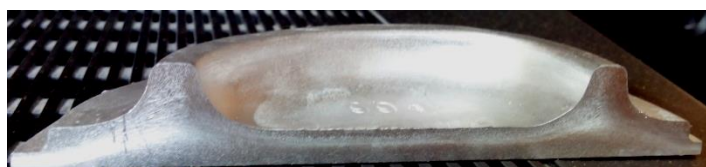
Рисунок 4.15 – Макроструктура поздовжнього перерізу штампованої поковки деталі «Основа»
