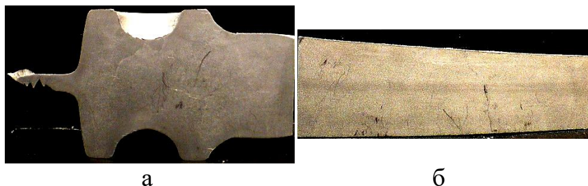
Рисунок 4.23 – Макроструктура поздовжнього розрізу штампованого вальцювання після кінцевого рівчача: а) макроструктура головки; б) макроструктура поздовжнього перерізу ребра
