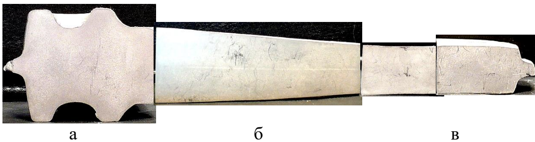
Рисунок 4.22 – Макроструктура поздовжнього розрізу штампованого вальцювання після підготовчого рівчача: а) макроструктура головки; б) макроструктура поздовжнього перерізу ребра; в) макроструктура другої головки
