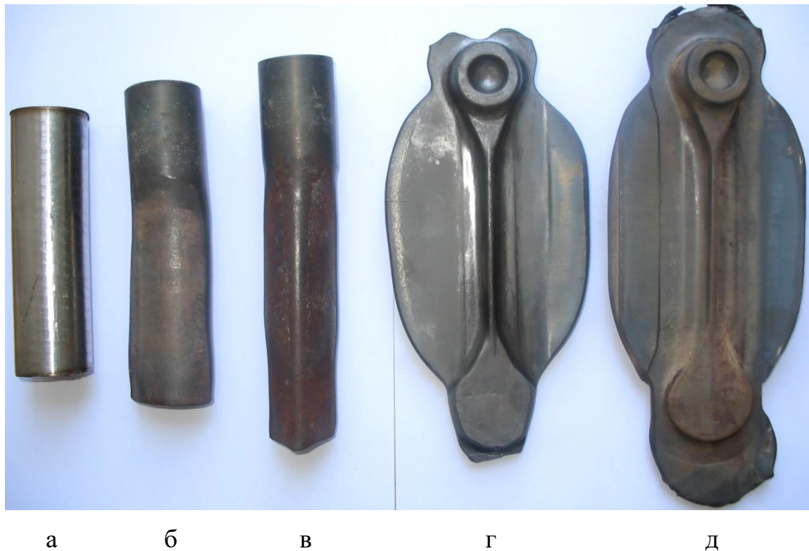
Рисунок 4.18 – Етапи виготовлення штампованої поковки «Качалка»: а) мірна заготовка; б) заготовка, що вальцюється, першого переходу «круг-овал»; в) вальцювальна заготовка другого переходу «овал-квадрат»; г) заготовка після підготовчого ривчака; д) штампована деталь
