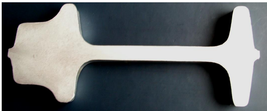
Рисунок 4.13 – Макроструктура поздовжнього перерізу штампованої поковки «Качалка», що виготовлена з вальцювальної заготовки
