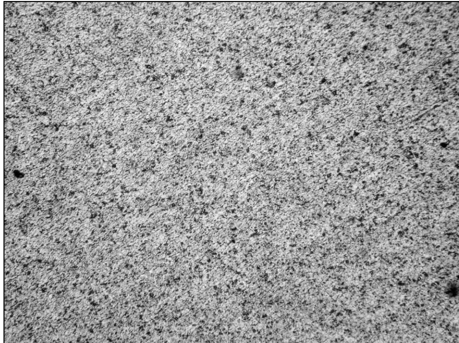
Рисунок 3.14 – Мікроструктура дроту зразка №4, х500
