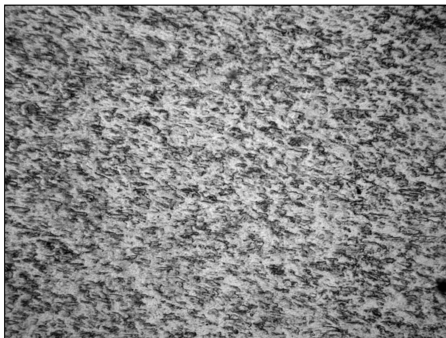
Рисунок 3.18 – Мікроструктура дроту зразка №5, x1000
