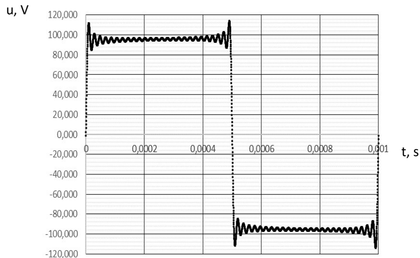
Рисунок 4.2 – Форма вихідної напруги для звичайного кабелю довжиною 10 м
