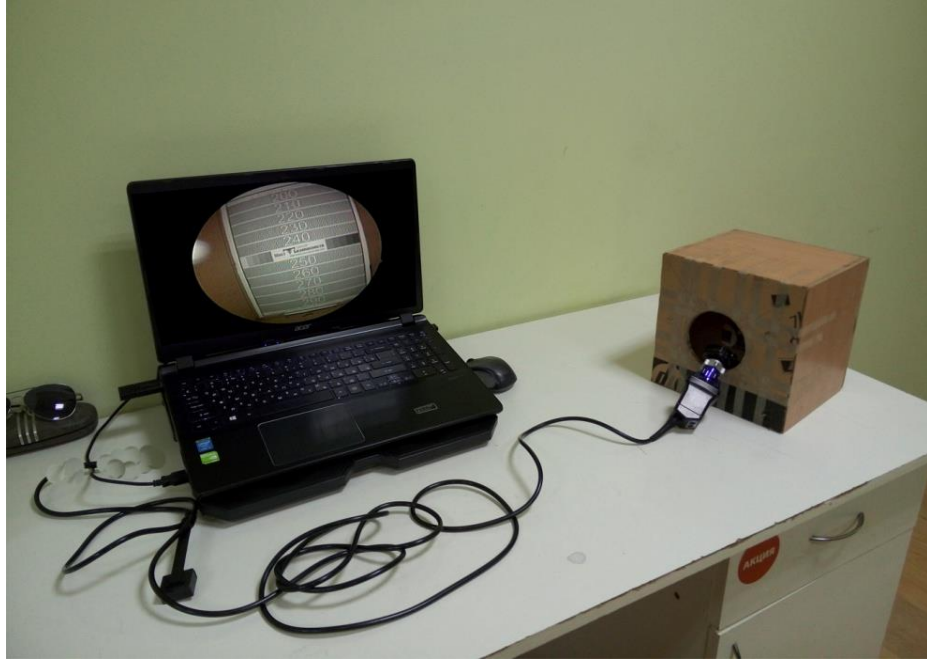
Рисунок 4.11 – Експериментальна модель тестування лапароскопічних відеокамер
