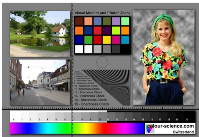
Рисунок 4.13 – Результати експерименту: а) Показники розподільної здатності лапароскопічної камери Olympus YKD-9007 (Olympus, USA ); б) вигляд тестової таблиці вимірювання роздільної здатності і деталізації.
