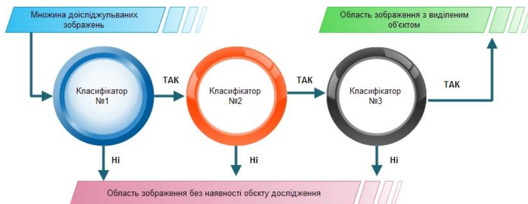
Рисунок В.1 – Принцип роботи каскадного класифікатора
