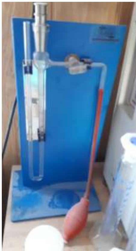
Рисунок 2.6 – Прилад для визначення питомої поверхні цементу та аналогічних порошків Blaine UTCM-0240
