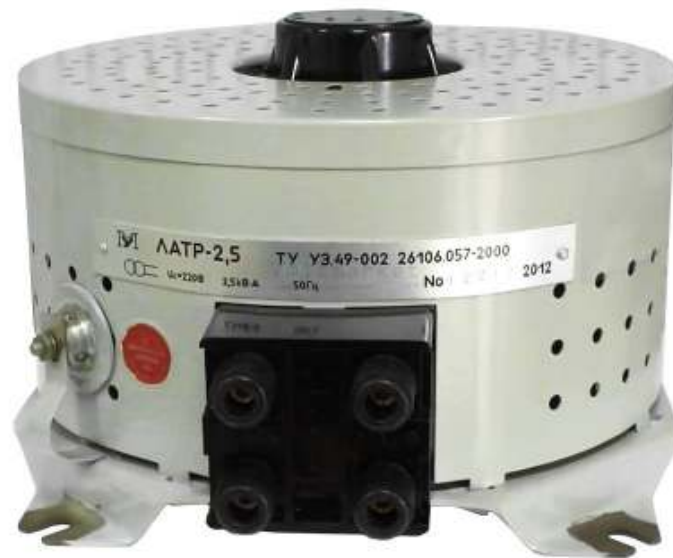
Рисунок 2.2 – Лабораторний автотрансформатор для регулювання швидкості обертання валу насадки змішувача
