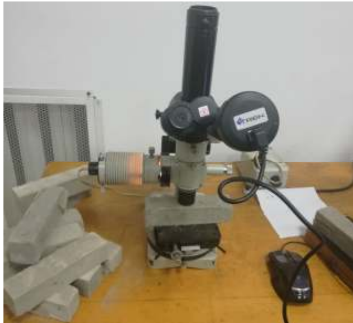
Рисунок 2.7 – Дослідження структури розчину за допомогою оптичної мікроскопії
